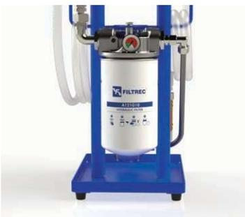
Encaixe o elemento filtrante, tendo o grau de filtração adequado para obter o nível de limpeza desejado.
