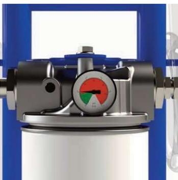
O filtro possui um indicador de saturação (manômetro), o elemento deve ser substituído quando o ponteiro atingir o setor vermelho.
