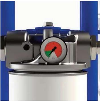
Verifique o código correto do elemento de substituição FILTREC, particularmente em relação à classificação de micron. Certifique-se de que a face de montagem esteja limpa, lubrifique a junta do elemento de substituição antes da montagem. Gire o novo elemento até que ele atinja a face de montagem e aperte por 3/4 de volta.
