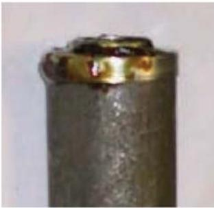
Durante o uso normal de um sistema hidráulico, o fluido lubrificante ou hidráulico pode separar substâncias insolúveis devido à degradação termo-oxidativa do próprio fluido.
