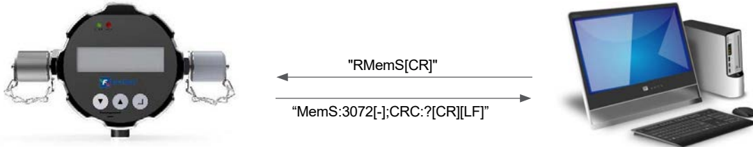
Fig. 24: Exemplo de transmissão de dados RS232 com checksum
