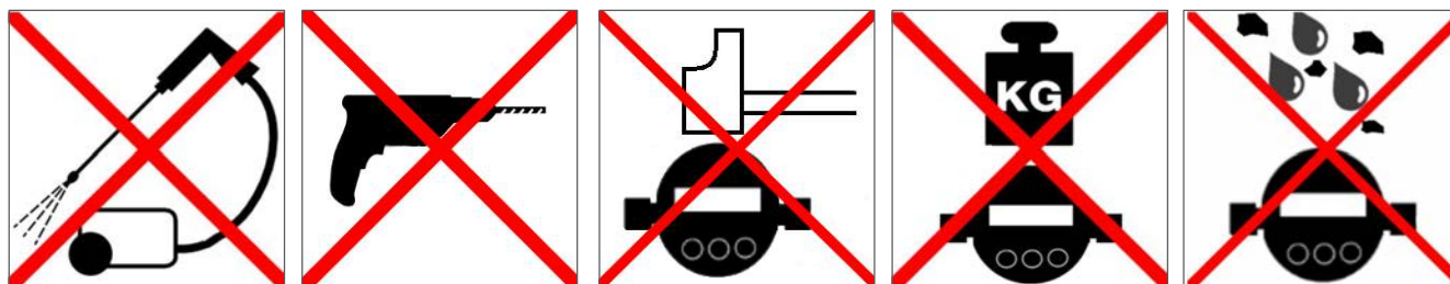
Fig. 9: Tensão mecânica inadmissível
